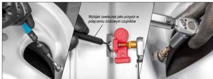
Wkręcanie wkładów zaworów 0,1–0,6 Nm
