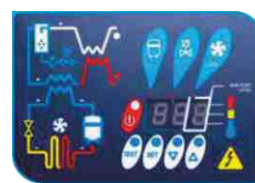
Osuszacz ziebniczy -Kompresory z serii New silver D są wyposażone w zintegrowany osuszacz ziebniczy. Panel osuszacza ziebniczego umożliwia stałe monitorowanie parametrów pracy. Posiada automatyczną funkcję oszczędzania energii.
