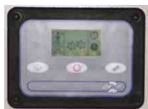
Sterownik FIAC EASY 2 CONTROL -zarządza, monitoruje i optymalizuje pracę kompresora
