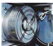
Inteligentny system chłodzenia -Kompresory z serii New silver są wyposażone w niezależne chłodzenie kontrolowane przez sterownik FIAC EASY 2 CONTROL. Utrzymanie stałej temperatury powietrza oraz oleju gwarantuje dużą żywotność podzespołów nawet w ciężkich warunkach.
